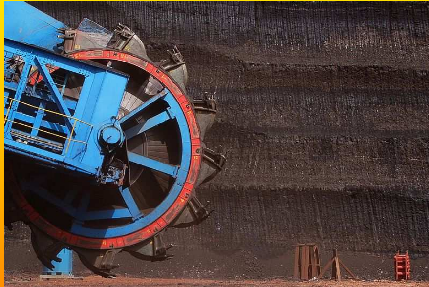
Rypadlo velostroje v dole Nástup Tušimice v Mostecké uhelné pánvi [5]
