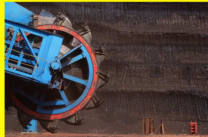
Rypadlo velostroje v dole Nástup Tušimice v Mostecké uhelné pánvi [2]
